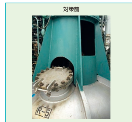
対策前 攪拌器軸への巻き込まれ防止のため、保護カバー(パンチングメタル)を取り付けました
