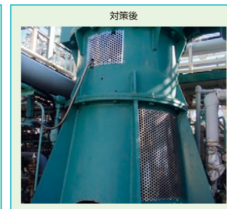
対策前 攪拌器軸への巻き込まれ防止のため、保護カバー(パンチングメタル)を取り付けました
